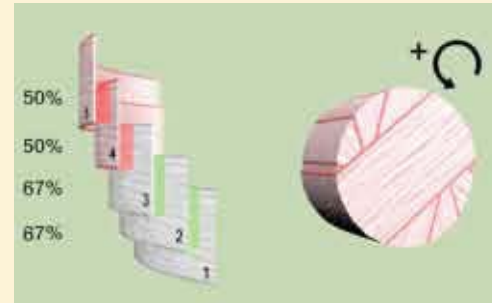
... permet de recouvrir normalement à 50% (2 couches)
