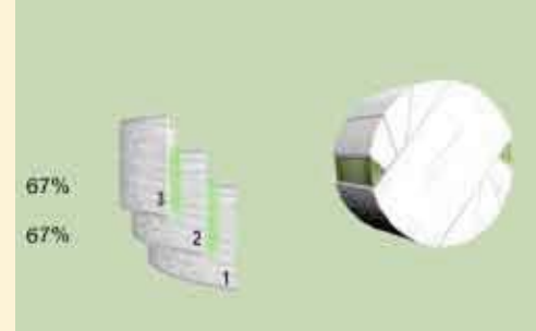
A 67% de recouvrement, la balle est enfilée avec 3 couches
