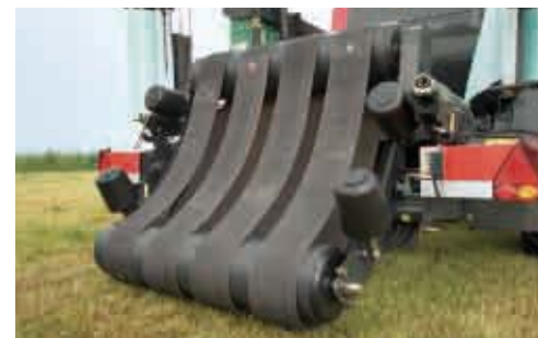
Un enfilage régulier en toutes conditions grâce à une table d'enfilage très basse munie de 4 courroies et de 2 rouleaux porteurs.
