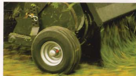
Roues de jauge pneumatiques disponibles en standard sur RF 2121 et RF 2125 (OptiCut)
