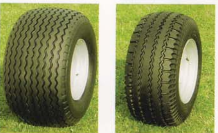
Les RF 2121 et RF 2125 sont équipées en standard de pneumatiques 11.5/80-15.3. Des pneus de 15.0/55-17 sont disponibles en option
