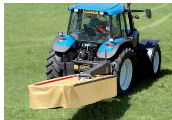
L'EXTRAΔ 440 est mise long derrière le tracteur par le biais d'un vérin hydraulique.
