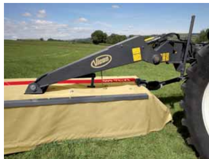
Connection pendulaire de l'unité de coupe sur le châssis porteur.
