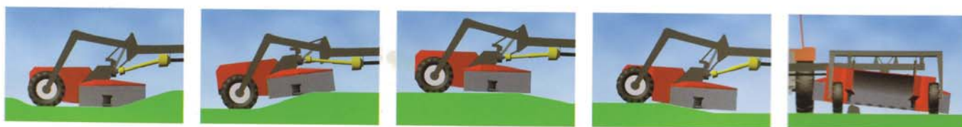
Adaptation unique au terrain grâce au principe de suspension flottante
