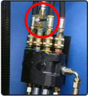
Distributeurs Monobloc grand débit avec vanne de sécurité pour le blocage du chargeur
