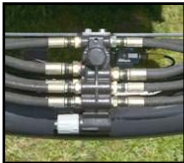
Valve QCV Incluant en standard les fonctions de levée/descente, cavage/bennage, clapets anti-choc, 3ème fonction commande 3 positions de l'ammortisseur SoftDrive
