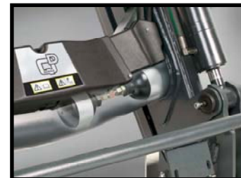
Clapets anti-choc évite les surpressions sur le chargeur
